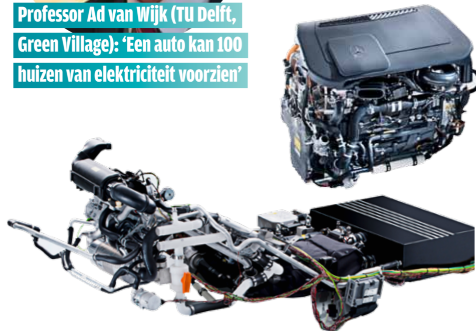
Het brandstofcelsysteem is door de jaren heen steeds compacter geworden. Boven het meest recente exemplaar.
